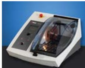
観察したい箇所のサンプリングを、精密切断機た放電加工機で行う
