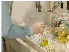
腐食液中に数秒漬けて取出し、洗浄して腐食を止め、アルコールに浸して乾燥機で乾燥
