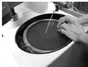
研磨上で試料を一定方向に研磨し、砥粒を細かくするごとに垂直方向に研磨する
