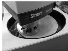
回転円盤上にバフ布を張り、微粒子アルミナを含む研磨液を滴下させ、回転円盤上に研磨
