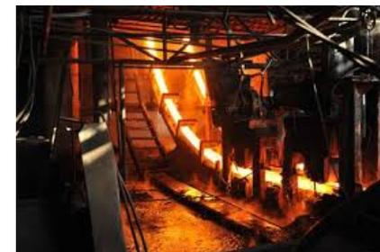
熱いうちに熱間圧延工程に送られるが、厳しい用途に使用される鋼は、表面・内部欠陥の検査のため、冷却後に圧延工程に送られる
