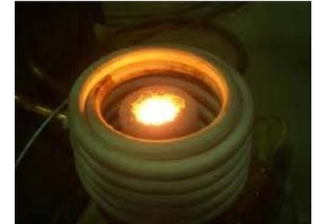
**鑄造**は、材料（鉄・アルミ・銅等の金属）を融点より高温で熱して液体にした後、型に流し込み、冷やして目的の形状に固める加工方法。鑄造に使用する型を鑄型と称し、鑄造でできた製品を鑄物と称する。英語で casting は、鑄造と鑄物の双方をさす。
