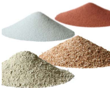
粘土( xM_2O \cdot yAl_2O_3 \cdot zSiO_2 \cdot nH_2O ) 長石( (Na, K, Ca, Ba)(Si, Al)_4O_8 ) 陶石( SiO_2, Al_2O_3, K_2O ), 石灰( CaCO_3 )
