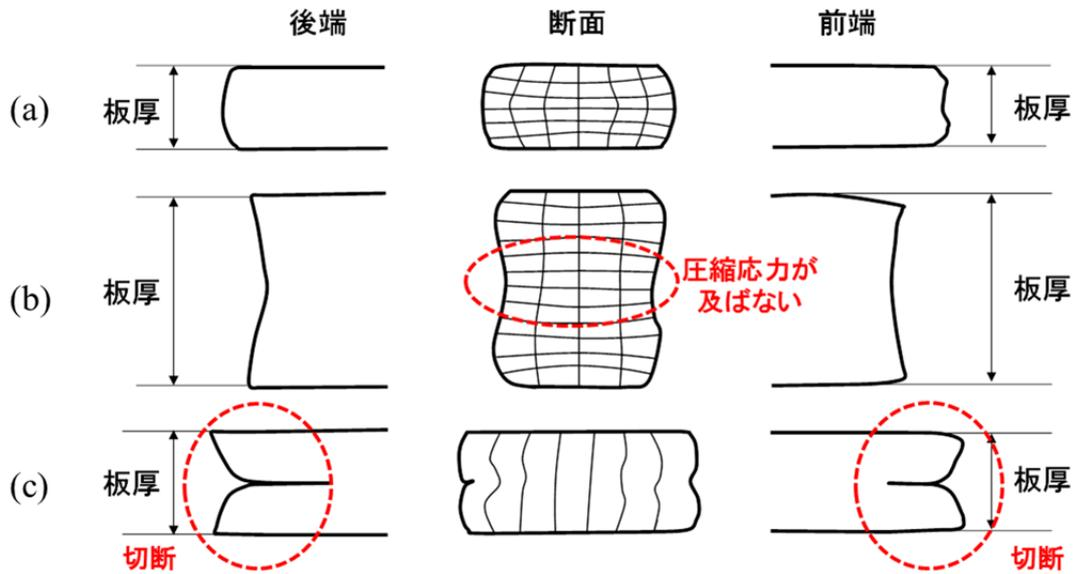
図 10 様々な不均一変形: バレリング(a)、ダブルバレリング(b)、ダブルバレリングの進展(c)
