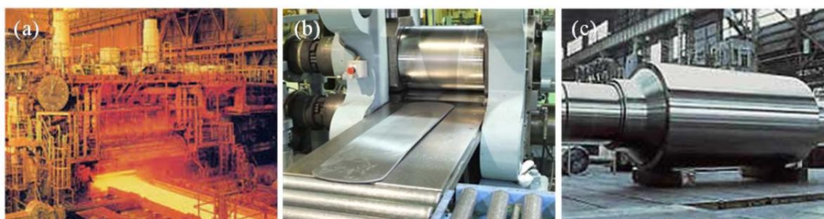
図1 熱間圧延(a)、冷間圧延(b)、圧延ロール(c)
