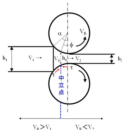
図8 中立点の位置を示す圧延側面図
