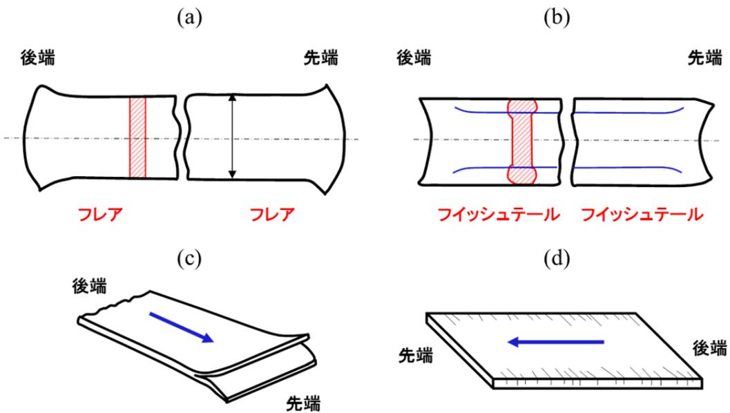
図 11 様々な不均一変形: 水平圧延(a)、板幅圧延(b)、ワニ口割れ(c)、耳割れ(d)
