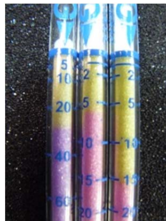
図 アンモニア吸引後のガス検知管. 数字は ppm 単位の濃度で、左より 30、6、15 ppm.
